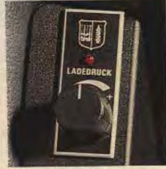
Alpina B 10 Biturbo: Ladedruck-Regelung für zwei Turbinen
