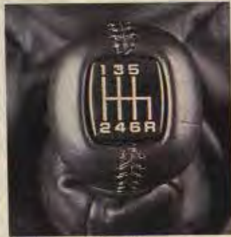
Opel Lotus Omega: Getrag-Getriebe mit sechs Gängen
